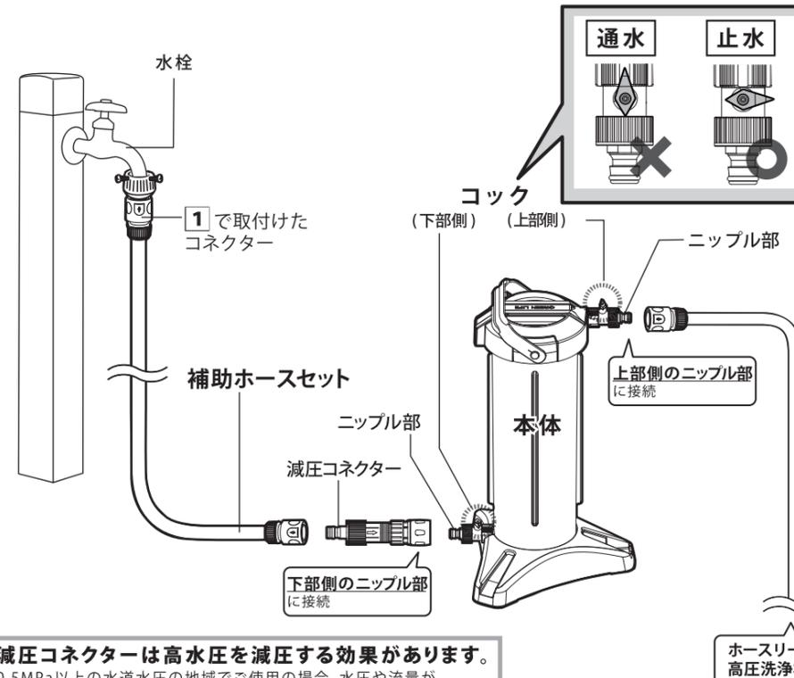
ご使用時に本体内部の水圧が急激に上昇することがありますので、通水中は本体上部側のコックを閉めて止水しないでください。
