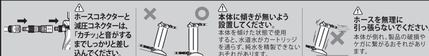
必ず下図通りに設置してください。誤って設置しますと、純水器本体に大きな圧力がかかり破裂するおそれがあります。
