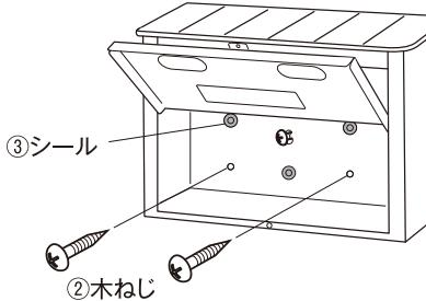
柱に取り付ける際は下段中央の穴を、壁に取り付ける際は下段左右2カ所の穴を使用し、②木ねじで①ポストを固定してください。最後に①で仮止めした②木ねじでしっかりと固定してください。
