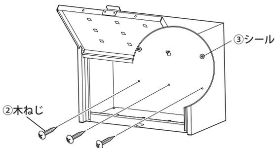
下部のネジ穴に残りの3本の②木ねじ で①本体 を固定してください。最後に 1 で仮止めした②木ねじ をしっかりと固定してください。取付けに使用しない穴は雨水の侵入防止の為、③シール でふさいでください。
