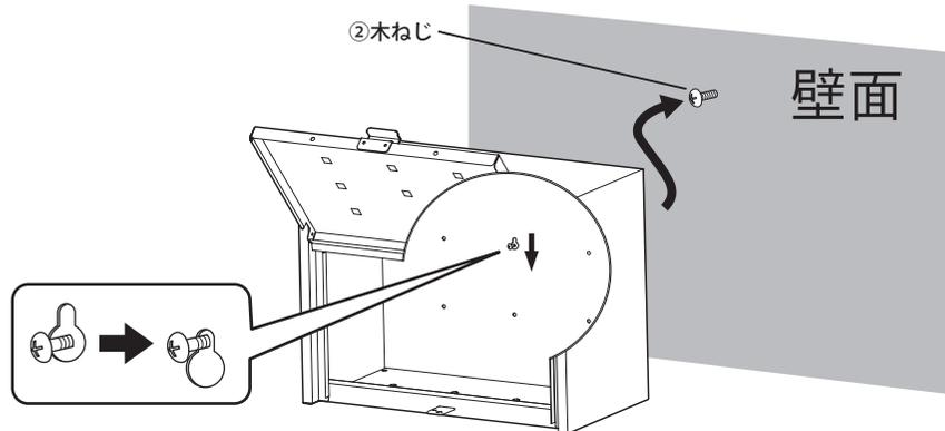
②木ねじ を壁面に仮止めし、①本体 上部の穴を付けてください。
