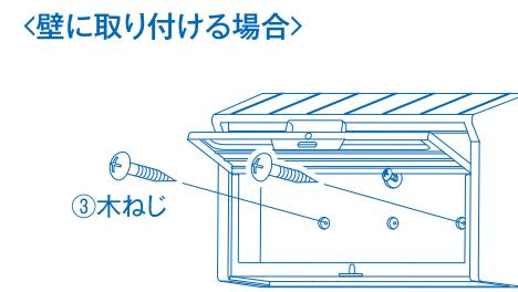
柱に取り付ける際は下段中央の穴に、壁に取り付ける際は下段左右2カ所の穴に、③木ねじを貫通させながら
