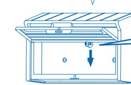
③木ねじを柱、又は壁に仮止めし、①ポスト上段中央の穴をかけてください。
