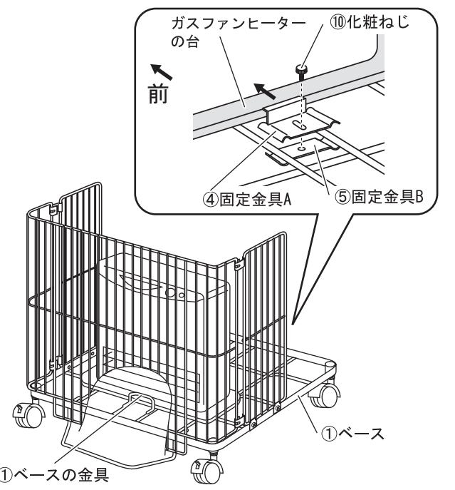
①ベースにガスファンヒーターをのせ、ガスファンヒーターの台を①
